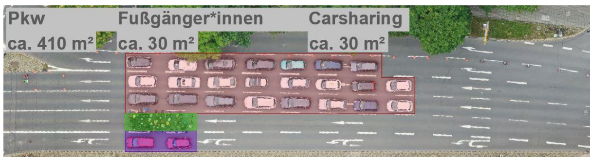
Abb. 9: Orthofoto mit belegten Flächen für Carsharing
